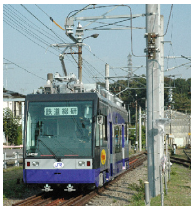
パンタグラフからの急速充電試験 (接触式)
