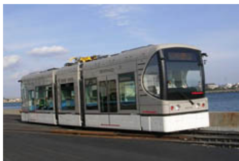
図表 15 ニッケル水素電池搭載 LRT の実証試験 (川崎重工業(株) 社製)
