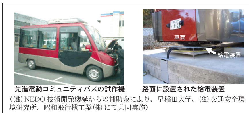
図表 17 電動コミュニティバスの実証試験
