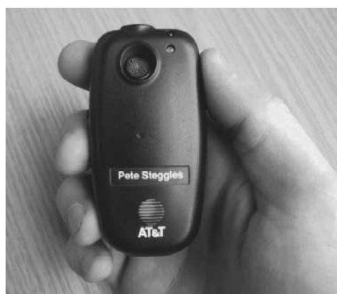
図表4 小型携帯端末 Bat (2 ボタン、2 LED、ブザー)
