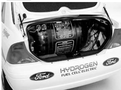
(a)乗用車のトランクスペースに収納された350気圧高圧水素タンク
