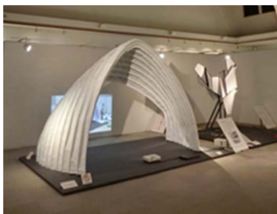
図表 3：展開すると硬くなる構造物 (左)展開時、(右)折り畳み時
