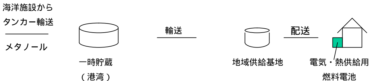
図 12 現在の電気・ガス供給と(将来の海洋風力由来メタノール利用)分散型電気・熱供給
