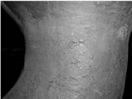
鉛ダンパー(関東地区)の亀裂(深さ約3mm)
