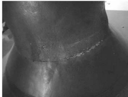
鉛ダンパー(東北地区)の亀裂(深さ約7mm)
